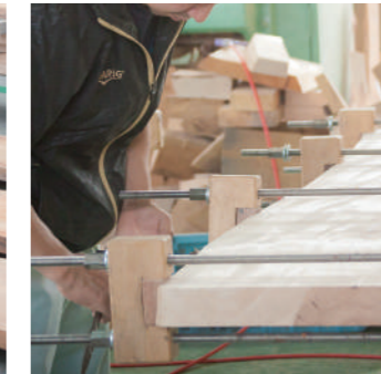
幅接着 手締め
