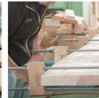
幅接着 手締め
